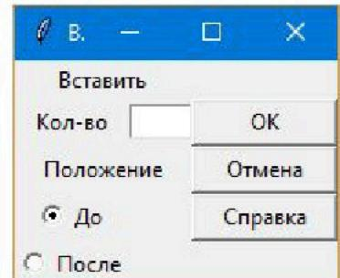
Слишком близкое расположение кнопок друг к другу исправляется с помощью опций padx и pady, которые позволяют заполнить пустотой место вокруг виджета.
