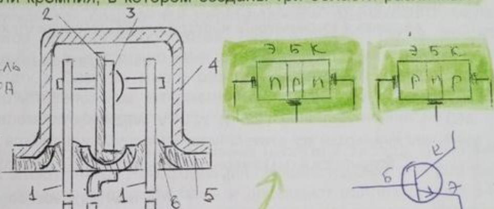
Две крайние области всегда однотипной проводимости, средняя противоположной. На рис. а) транзистор типа п-р-п на рис. б) транзистор типа р-п-р .
