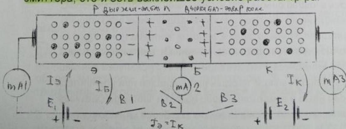
Транзистор представляет собой два п/проводниковых диода имеющих одну общую область – базу, причём эмиттерному переходу приложено напряжение  $E_1$ , в прямом (пропускном) направлении, а к коллекторному пе
