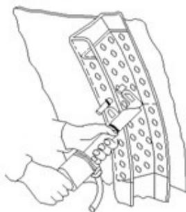
Рис. 9.3 – Применение ручного пневморычажного пресса при ремонте шпангоута
