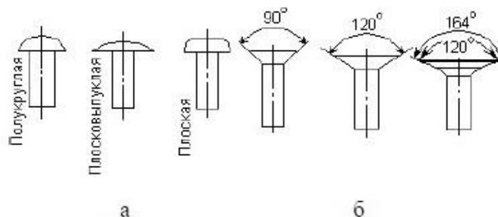
а – заклепки с выступающими головками; б – заклепки с потайными головками
