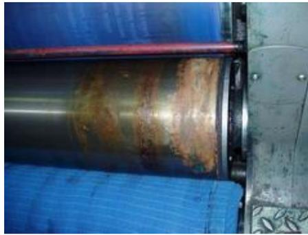
Рис. 1.7 – Коррозионный износ
