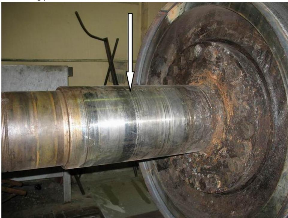
Рис. 1.3 – Абразивный износ
