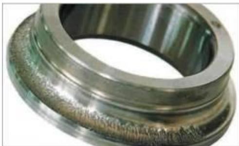
Рис. 1.1 – Контактный износ кольцевой поверхности втулки
