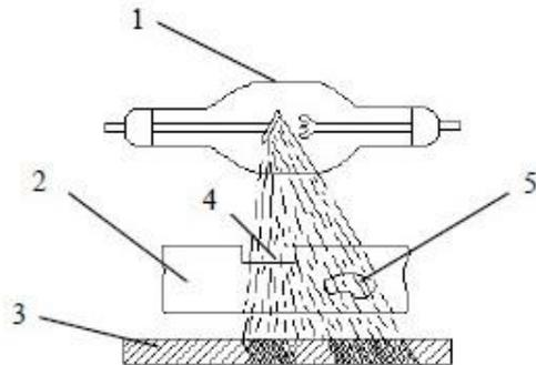
1 – рентгеновская трубка; 2 – деталь; 3 – кассета с пленкой; 4 – углубление в детали;
