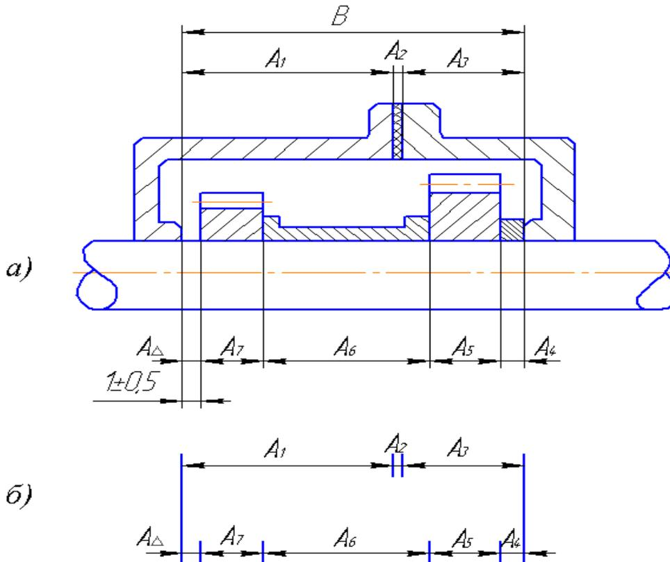
Рис. 10.1 – Схема простановки размеров (а) и построения размерной цепи (б) сборочного узла
