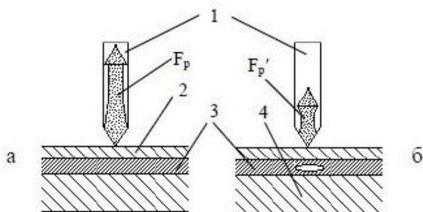
1 – датчик; 2 – внешний лист (обшивка); 3 – слой клея; 4 – внутренний элемент конструкции;
