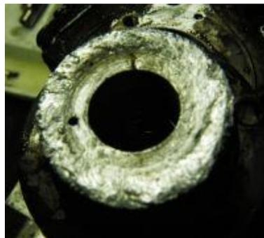
Рис. 1.8 – Усталостный износ
