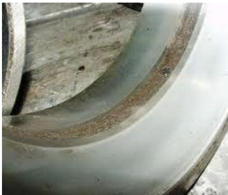
Рис. 1.2 – Окислительный износ внутренней беговой дорожки
