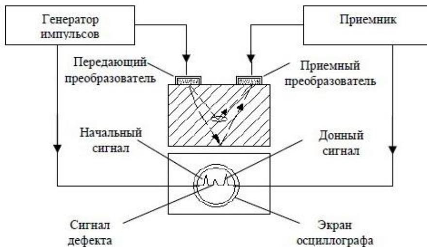
Рис. 5.3 – Схема работы импульсного ультразвукового дефектоскопа
