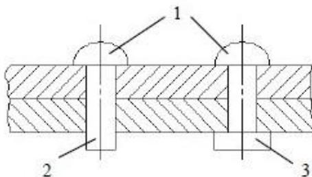
1 – закладная головка; 2 – стержень; 3 – замыкающая головка
