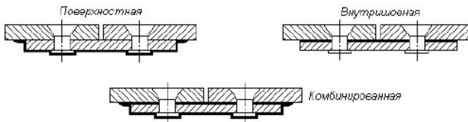
Рис. 9.6 – Схемы герметизации заклепочных соединений
