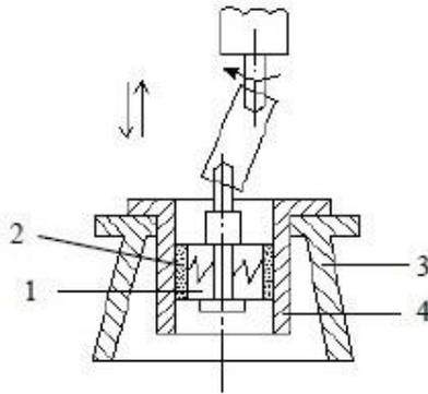
1 – корпус хонинговальной головки; 2 – брусок; 3 – пружина; 4 – обрабатываемая деталь
