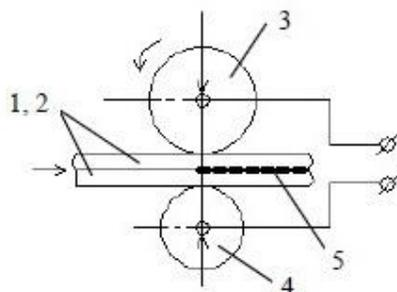
1,2 – соединяемые детали; 3 – верхний ведущий ролик;
