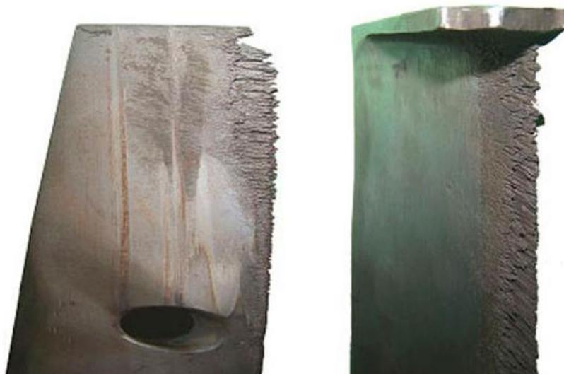
Рис. 1.4 – Эрозионный износ лопаток
