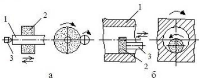
1 – деталь; 2 – шлифовальный круг; 3 – крепление детали (инструмента)
