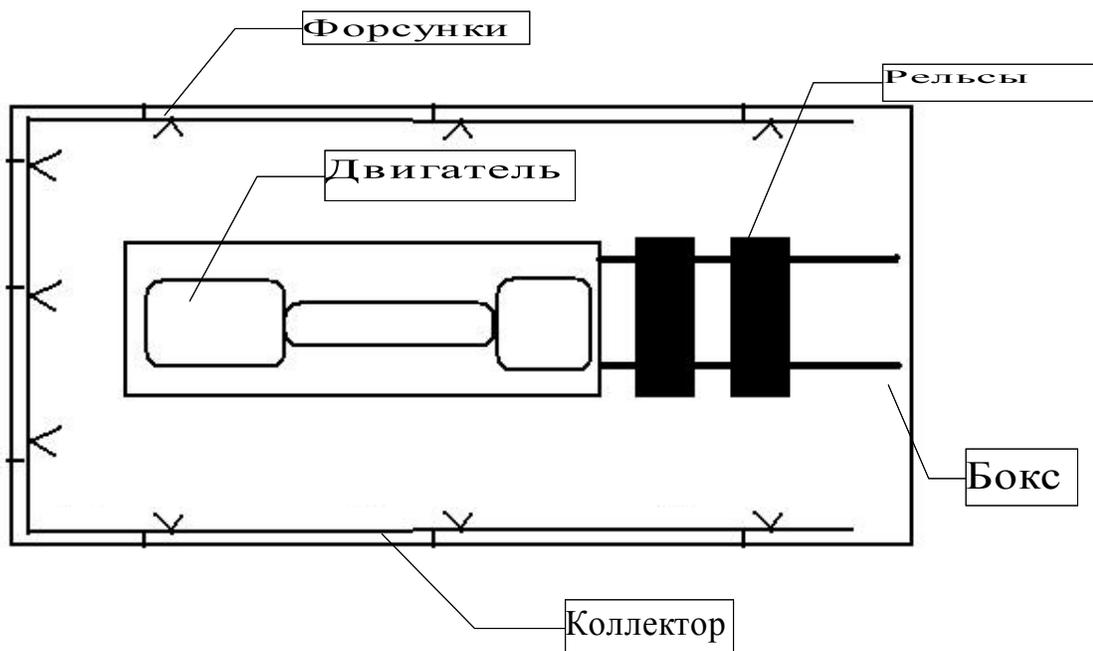
Рис. 4.1 – Схема автоматической промывки
