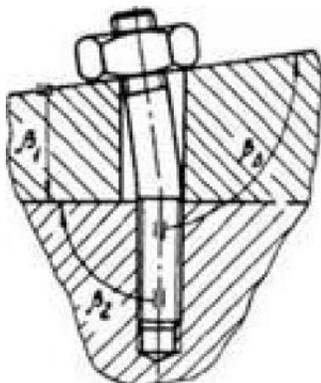
Рис. 1.6 – Деформационный износ
