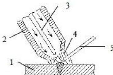
1 – деталь; 2 – корпус горелки; 3 – вольфрамовый электрод;
