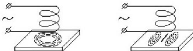
Рис. 5.9 – Схема вихретокового неразрушающего контроля
