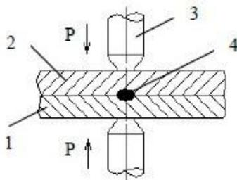
1, 2 – соединяемые детали; 3 – электроды; 4 – сварочная точка
