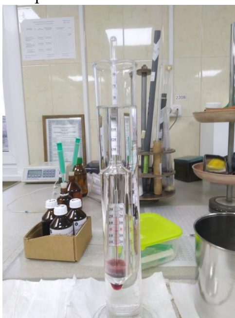
Рисунок 1 – Определение плотности ареометром
