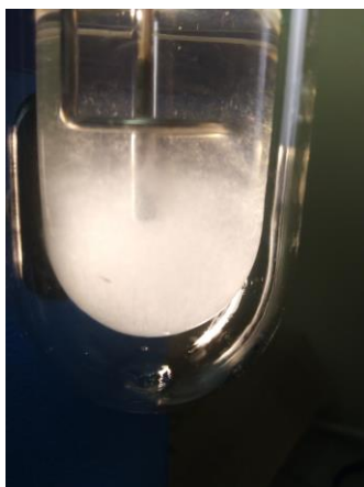
Рисунок 7 – Определение температуры начала кристаллизации
