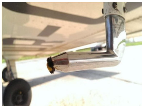
Рисунок 2 – Закупорка ППД насекомым
