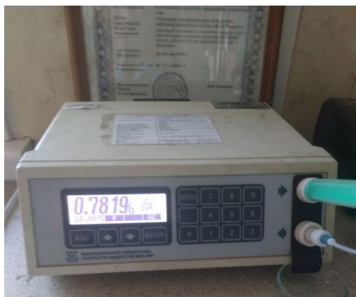
Рисунок 2 – Определение плотности плотномером
