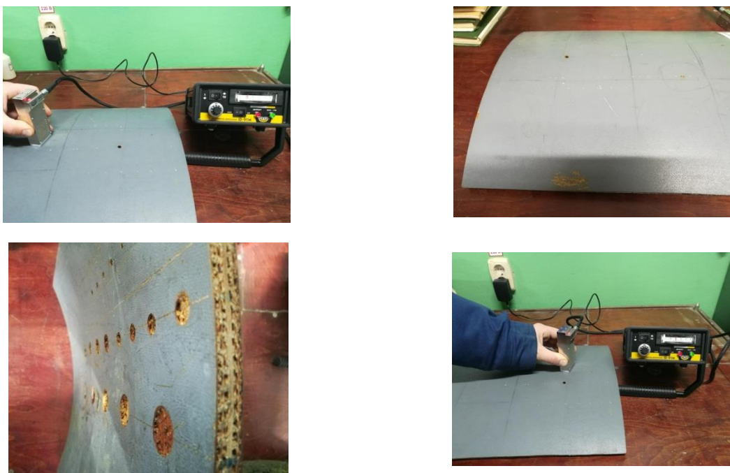
Рисунок 8 – Проведение акустического импедансного метода контроля
