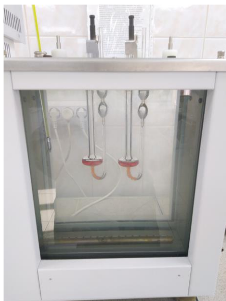
Рисунок 6 – Термостатирующая баня для определения вязкости
