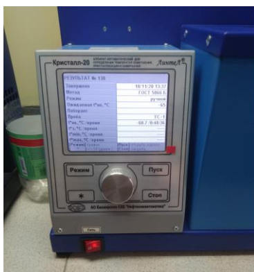
Рисунок 8 – Результат определения температуры начала кристаллизации на Кристалл-20
