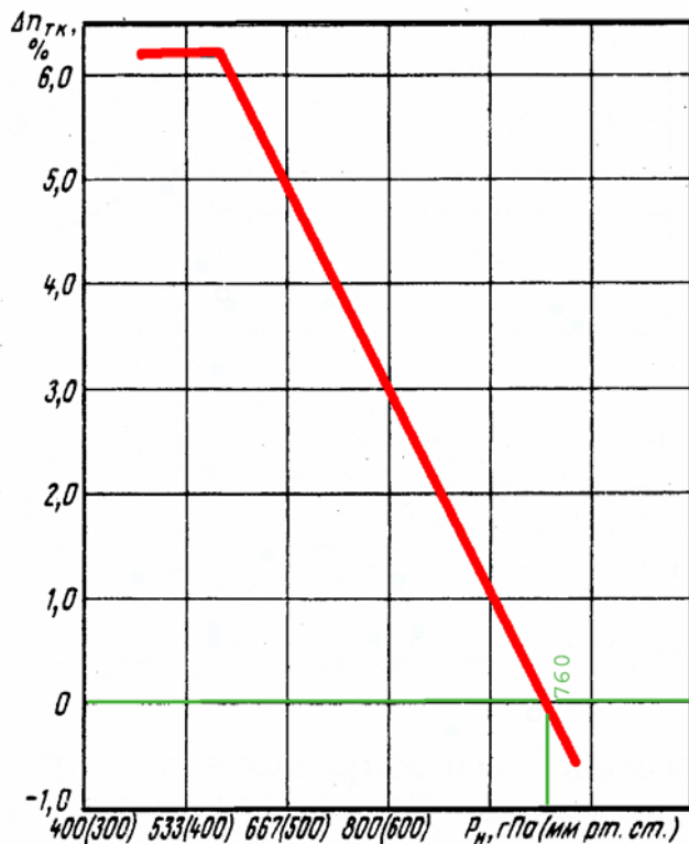
Рис. 4.7. Определение поправок \Delta n_{TK} для взлетного режима в зависимости от атмосферного давления (по закону, заложенному в ЭРД)
