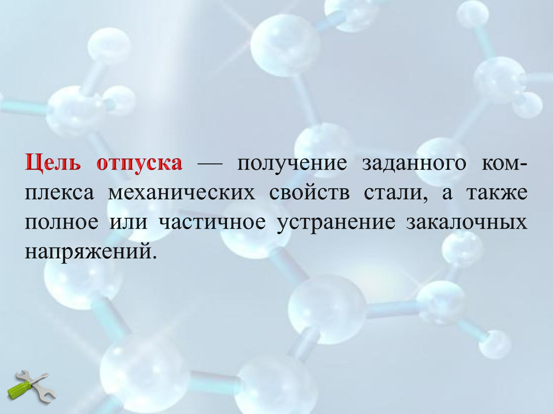
**Цель отпуска** — получение заданного комплекса механических свойств стали, а также полное или частичное устранение закалочных напряжений.
