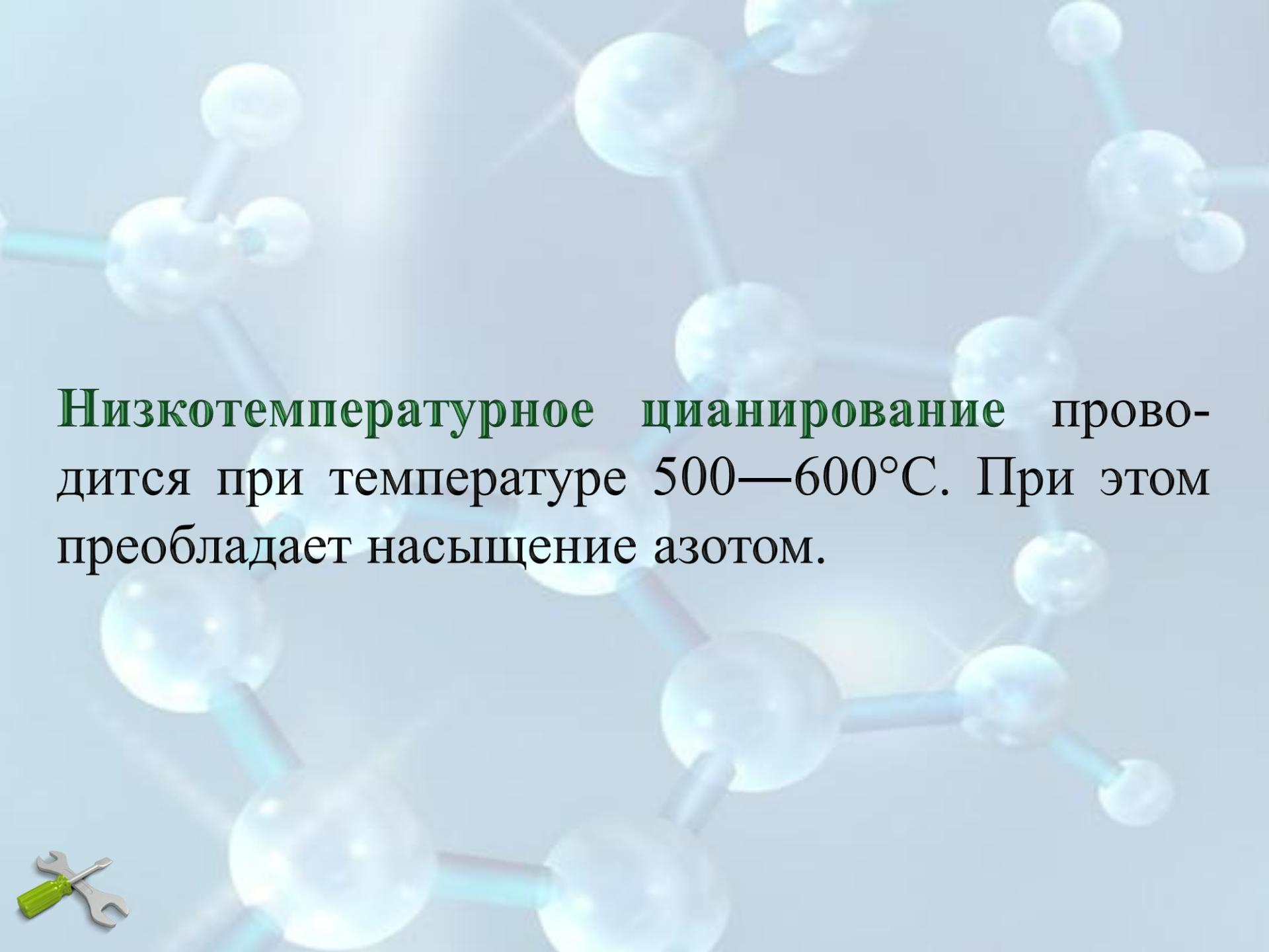
**Низкотемпературное цианирование** проводится при температуре 500—600°C. При этом преобладает насыщение азотом.
