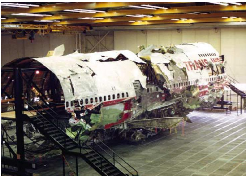
Рис. 1.1.10. Раскладка обломков рейса TWA800
