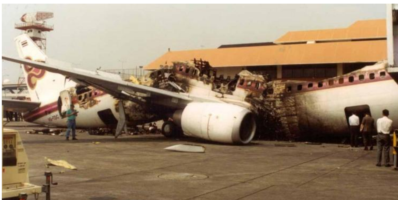
Рис. 1.1.3. Самолет B737-400 компании ТАІ после взрыва центрального топливного бака
