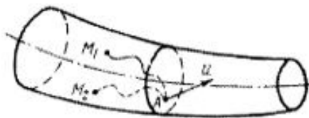
Рис. 5.6. Схема, поясняющая понятие мгновенной местной скорости
