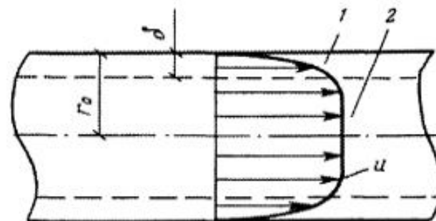
Рис. 5.9. Условная схема разделения потока жидкости в трубе на вязкий подслой 1 и турбулентное ядро 2
