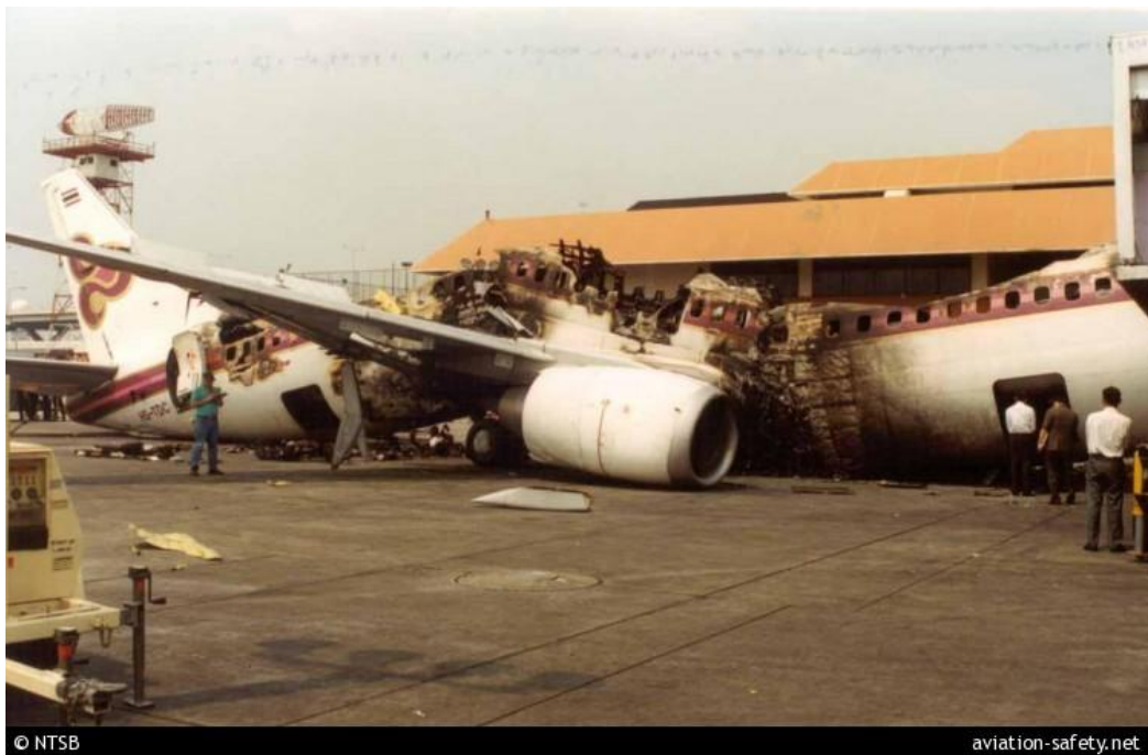
Рисунок 2 – Самолет В737-400 компании ТАІ после взрыва центрального топливного бака
