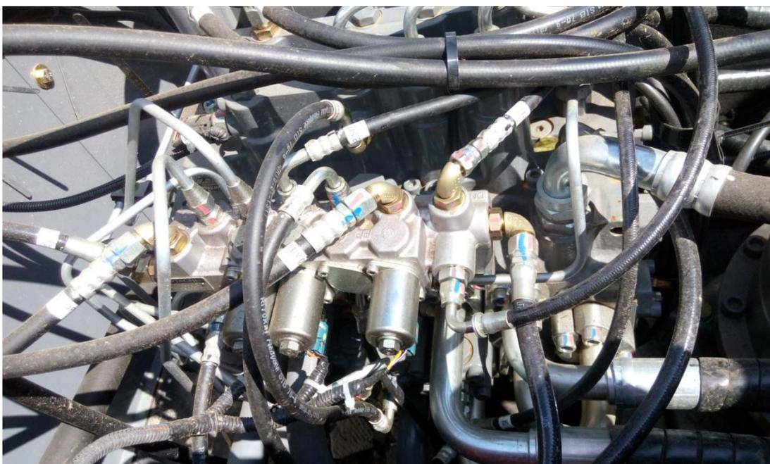
Рис. 3.24. Гидролинии в гидроприводе
