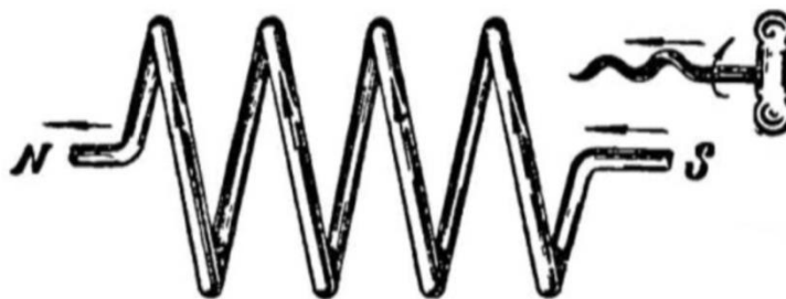
Рис. 9. Определение полюсов соленоида
