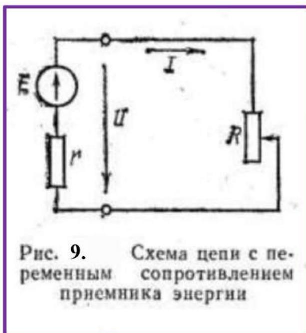
Режим работы электрической цепи, т. е. ее электрическое состояние, определяется величинами токов, напряжений и мощностей ее отдельных элементов.
