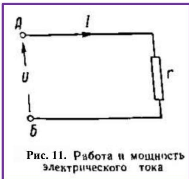
За время  $t$  по цепи протекло количество электричества  $Q$ . Силы электрического поля, действующего вдоль проводника, перенесли за это время заряд  $Q$  из точки А в точку Б. Работа электрических сил поля или, что то же, работа электрического тока может быть подсчитана по формуле:
