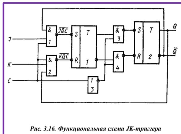
Рис. 3.16. Функциональная схема JK-триггера
