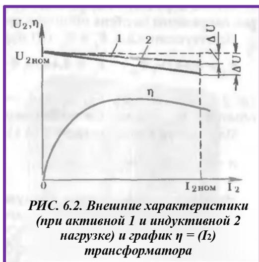
В трансформаторе, как и во всяком преобразователе энергии, часть энергии теряется — переходит в тепло. Эта энергия называется потерями. Основные потери в трансформаторе составляют потери: в магнитопроводе (потери в стали) на вихревые токи и гистерезис и в обмотках (потери в меди).
