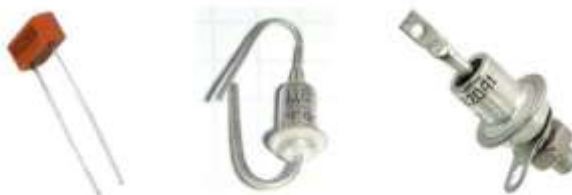
Рис. 11. Полупроводниковые стабилитроны. Стабилитроны используют для стабилизации напряжения.
