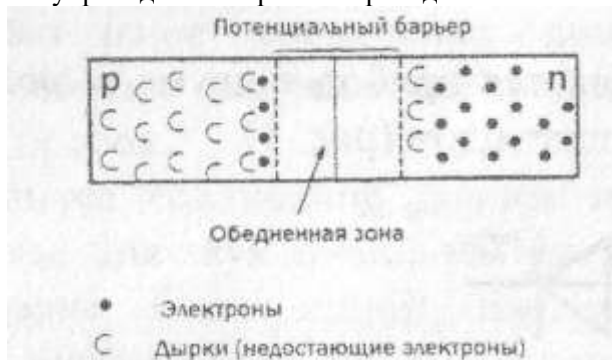
Рис. 20, p - n -переход без внешнего напряжения
