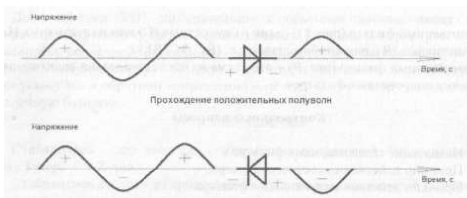
Прохождение отрицательных полувольт Рис. 13. Схемы включения диодов
