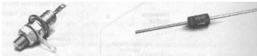
Рис. 12. Выпрямительные диоды разной мощности
