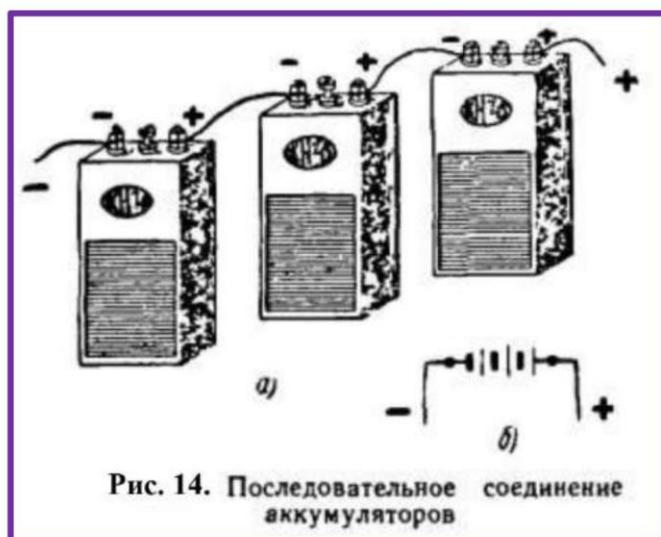
Рис. 14. Последовательное соединение аккумуляторов
