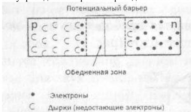
Рис. 20,  $p$ - $n$ -переход без внешнего напряжения
