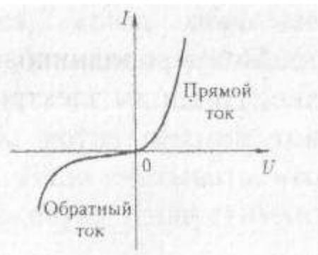
Рис. 21, Вольтамперная характеристика  $p$ - $n$  перехода
