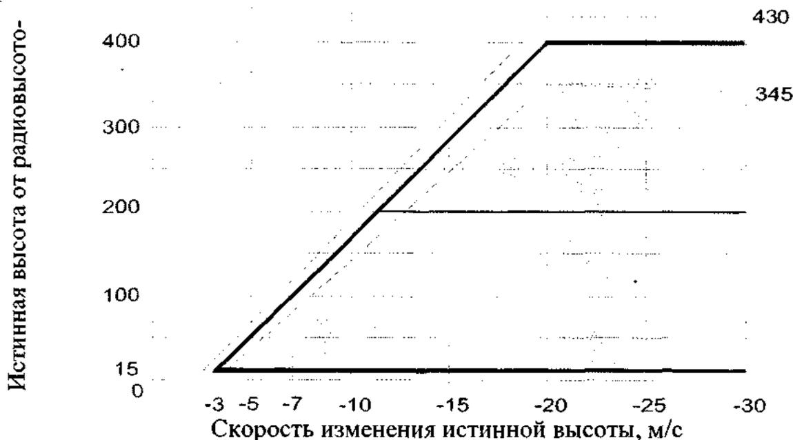
Рис. 7.19.1.4. Границы сигнализации режима 2.
