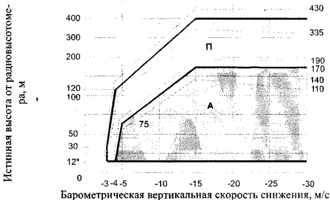
Рис. 7.19.1.3. Границы сигнализации режима 1
