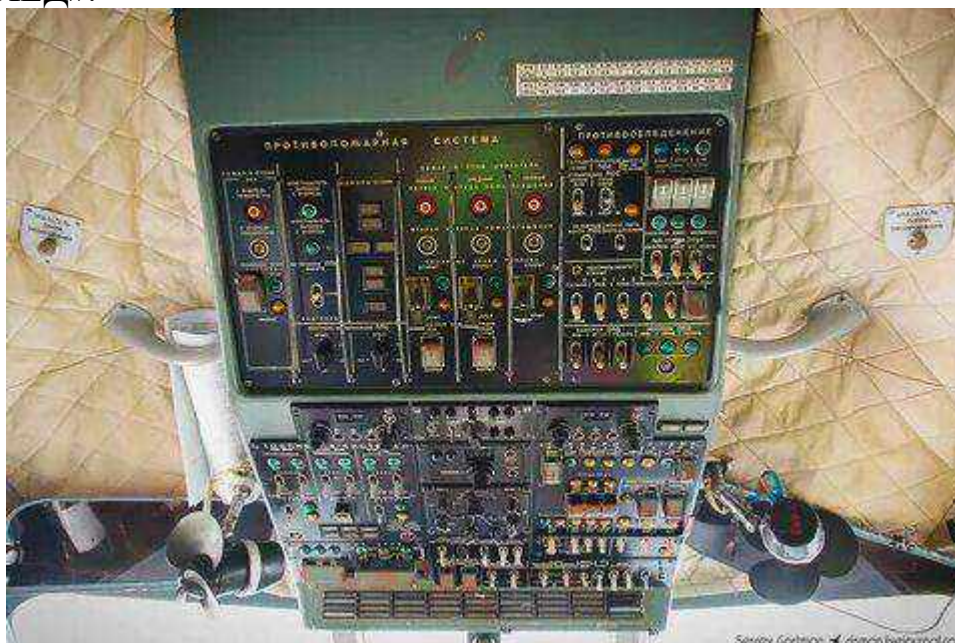
Рис 7. Щиток противообледенительной системы.
