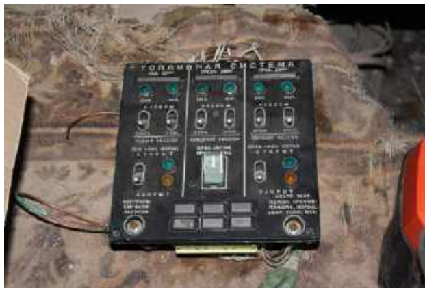
Рис 2. Щиток топливной системы.
