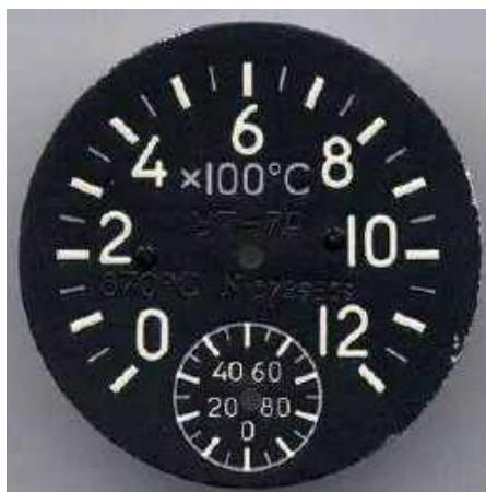
Рис 3. Указатель температуры УТ – 7А.
