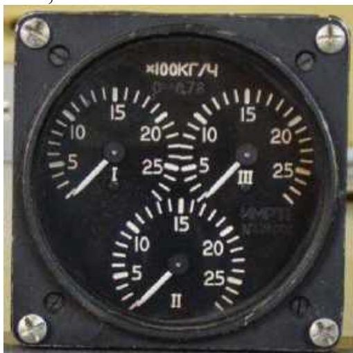
Рис 2. Индикатор мгновенного расхода топлива ИМТР-1.
