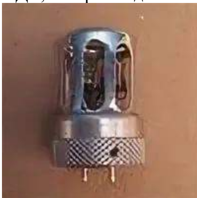
Рис 4. Датчик пожарной сигнализации ДПС -1А.
