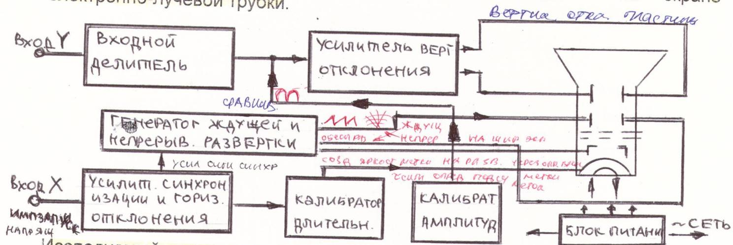
Исследуемый сигнал подаётся на вход прибора (вход Y). При чрезмерной величине сигнал ослабляется входным делителем. Далее он усиливается усилителем вертикального отклонения и подаётся на вертикально отклоняющие пластины ЭЛТ. Амплитуда входного сигнала может быть измерена посредством сравнения её с известной амплитудой калиброванного сигнала, выдаваемого калибратором амплитуды.
