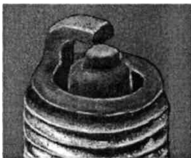
в - закопченная свеча
