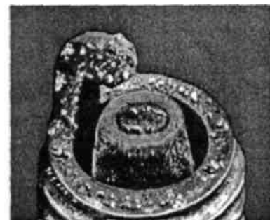
г - замасленная свеча
