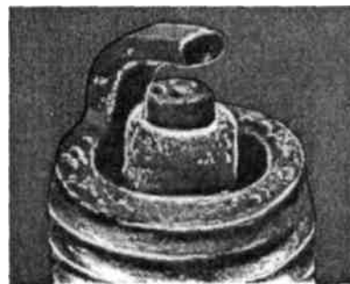
г - замасленная свеча
