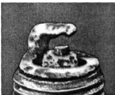
в - закопченная свеча
