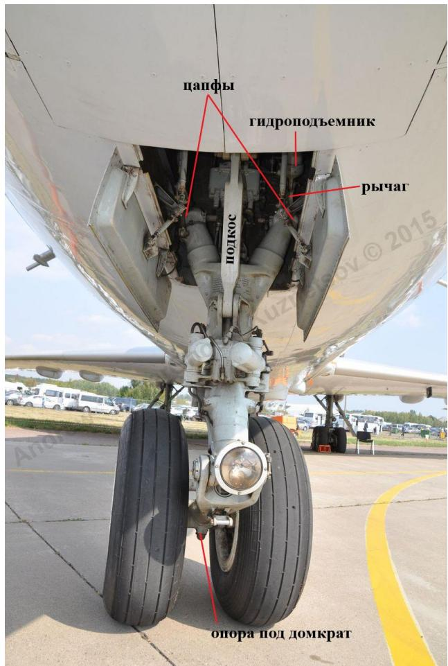
Наружный стакан (4) сварен из трех частей. В верхней части стакана расположены цапфы крепления его к фюзеляжу и проушины для установки рычага (1) крепления гидроподъемника. В нижней части спереди, расположены уши крепления подкоса и проушины для кронштейнов крепления цилиндров поворота передней опоры.
