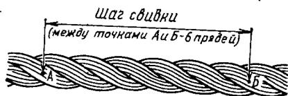
Рис. 26. Определение шага свивки каната тросов (ТК № 3, вып. 1)
