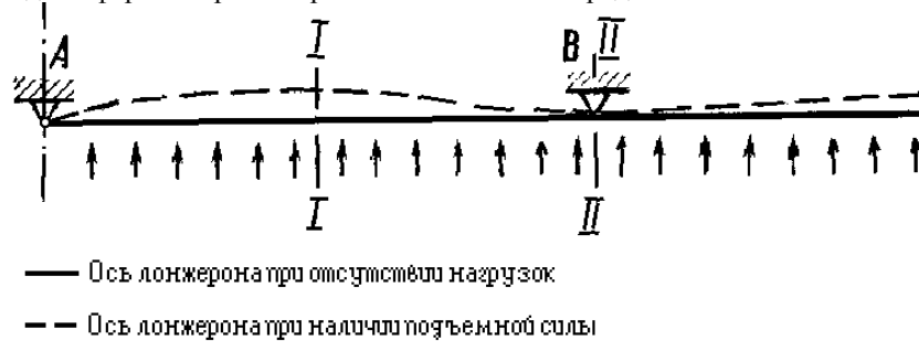
Рис. 3.20. Деформация лонжерона верхнего крыла при наличии подъемной силы:
