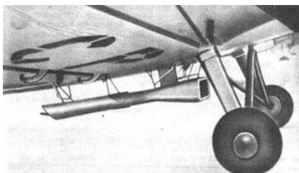
Рис. 2. Туннельный распылитель для порошкообразных химикатов на самолете Ан-2СХ
