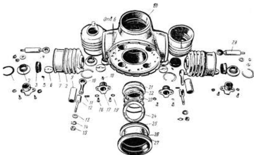
Рис. 5.5. Узел корпуса втулки винта (в разобранном виде):
