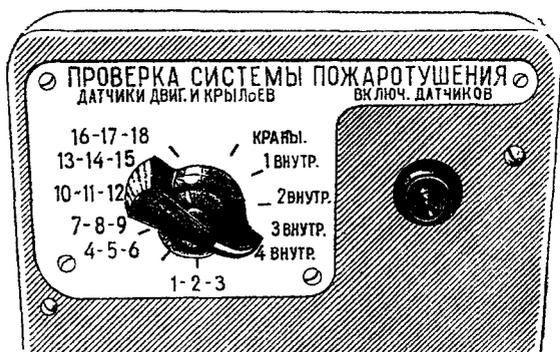
Фиг. 149. Щиток контроля и проверки пожаротушения
