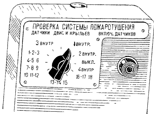
Фиг. 14. Щиток проверки системы пожаротушения
