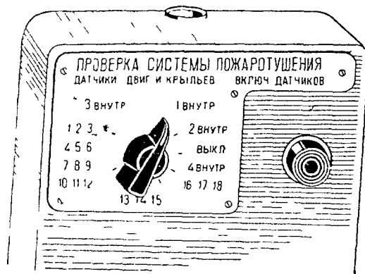
Фиг. 148. Щиток контроля системы пожаротушения
