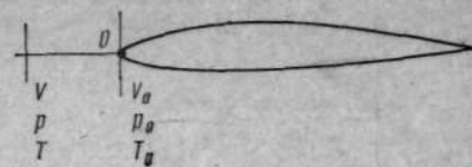
Рис. 3.2. Точка полного торможения (критическая) потока
